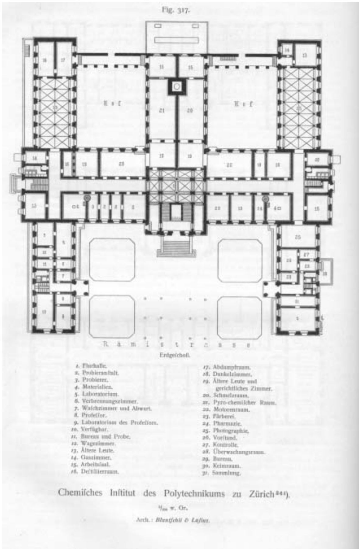
Abb.102 CHEMIEGEBÄUDE, Grundriß Erdgeschoß
