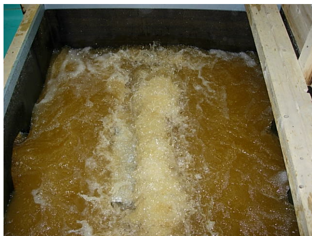
Abb. 5.13: Regelmäßiges Strömungsbild im Mönchsbauwerk bei gezielter Energieumwandlung mittels Prallplatte.
