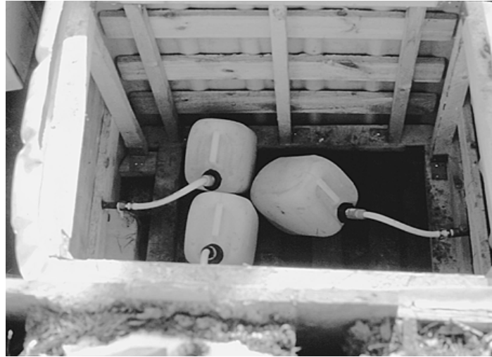
Foto 1 und 2: Herstellung eines Bodenmonoliths nach dem sog. Stechzylinderprinzip (links); Blick in den Messschacht mit den Ablaufvorrichtungen für das Sickerwasser aus den Lysimetern in die Auffangbehälter (rechts) (Fotos: Tressel 1994).
