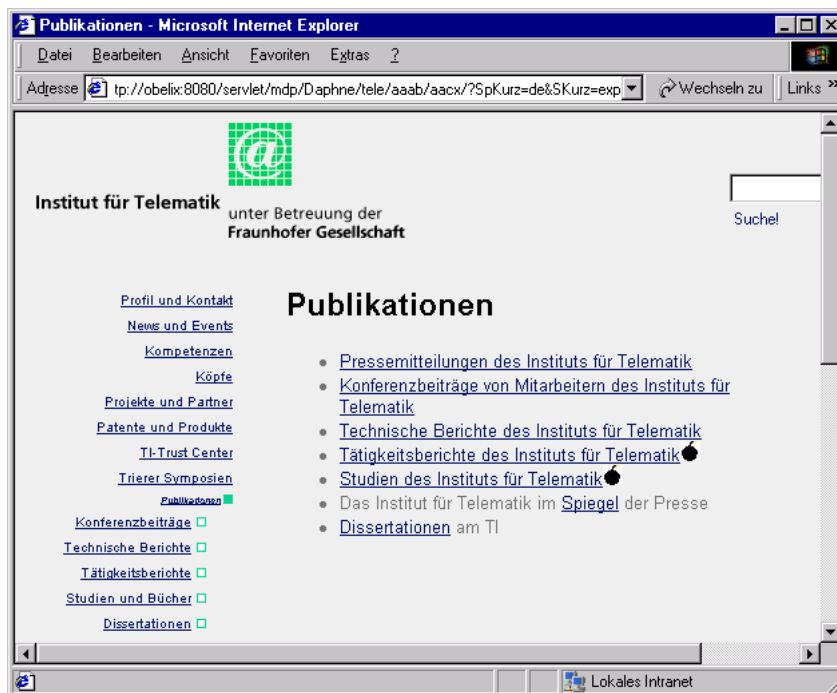
Abbildung 6.7: Die Visualisierung von broken Hyperlinks (im Zustand „In Bearbeitung“) und nicht aktiven Hyperlinks (in allen anderen Zuständen) durch „Bömbchen“ mit der Voransicht eines Dokuments.
