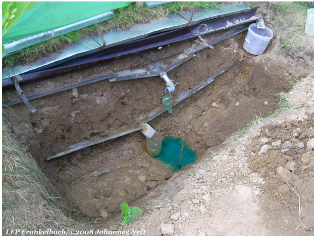
Abbildung 4.11.: Erfassung des Abflusses in drei Tiefen am Großberegnungsstandort Nr. 1.
