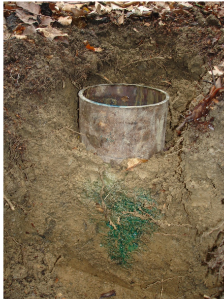
Abbildung 5.24.: Mit Brilliant Blue markiertes Sickerwasser im Unterbodenhorizont des Laubwaldstandorts Nr. 13 (Hangaufwärts gerichtete Aufnahme nach Ende des Infiltrationsversuchs, Ringdurchmesser: 15 cm).
