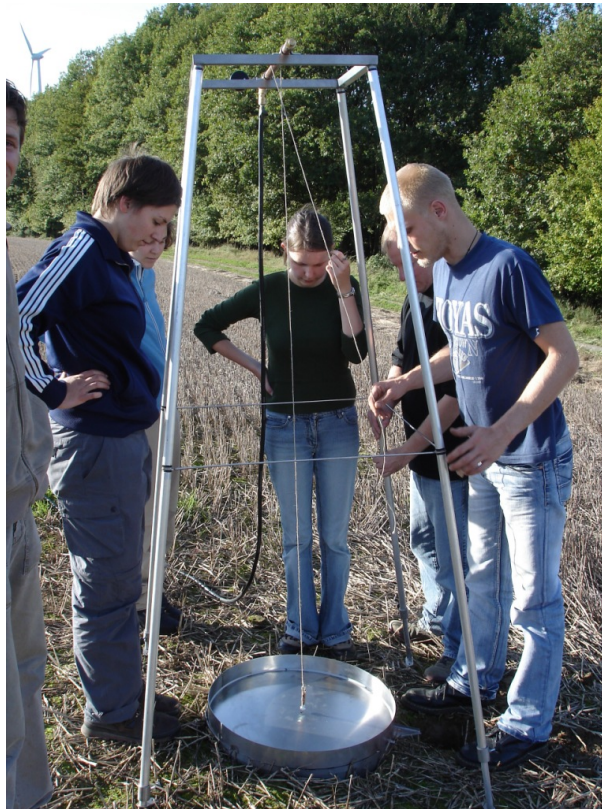
Abbildung 4.10.: Justierung der Kleinberegnungsanlage am Standort Nr.12 (Beregnungsfläche ist zur Überprüfung der Niederschlagsintensität von Kalibrierplatte bedeckt).
