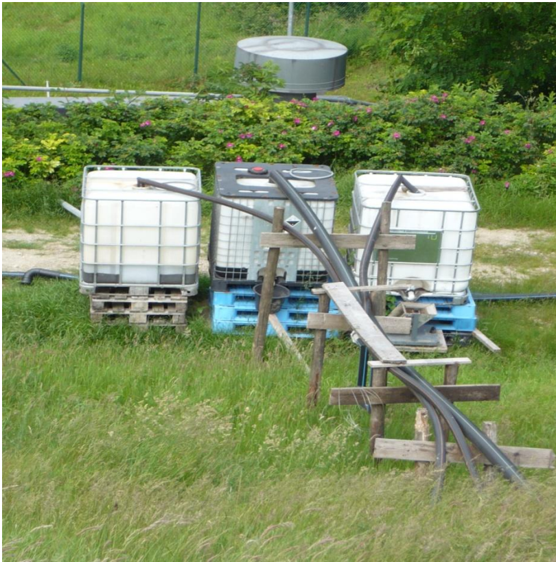
Bild 18: Einleitung der Abflüsse in Messcontainer
