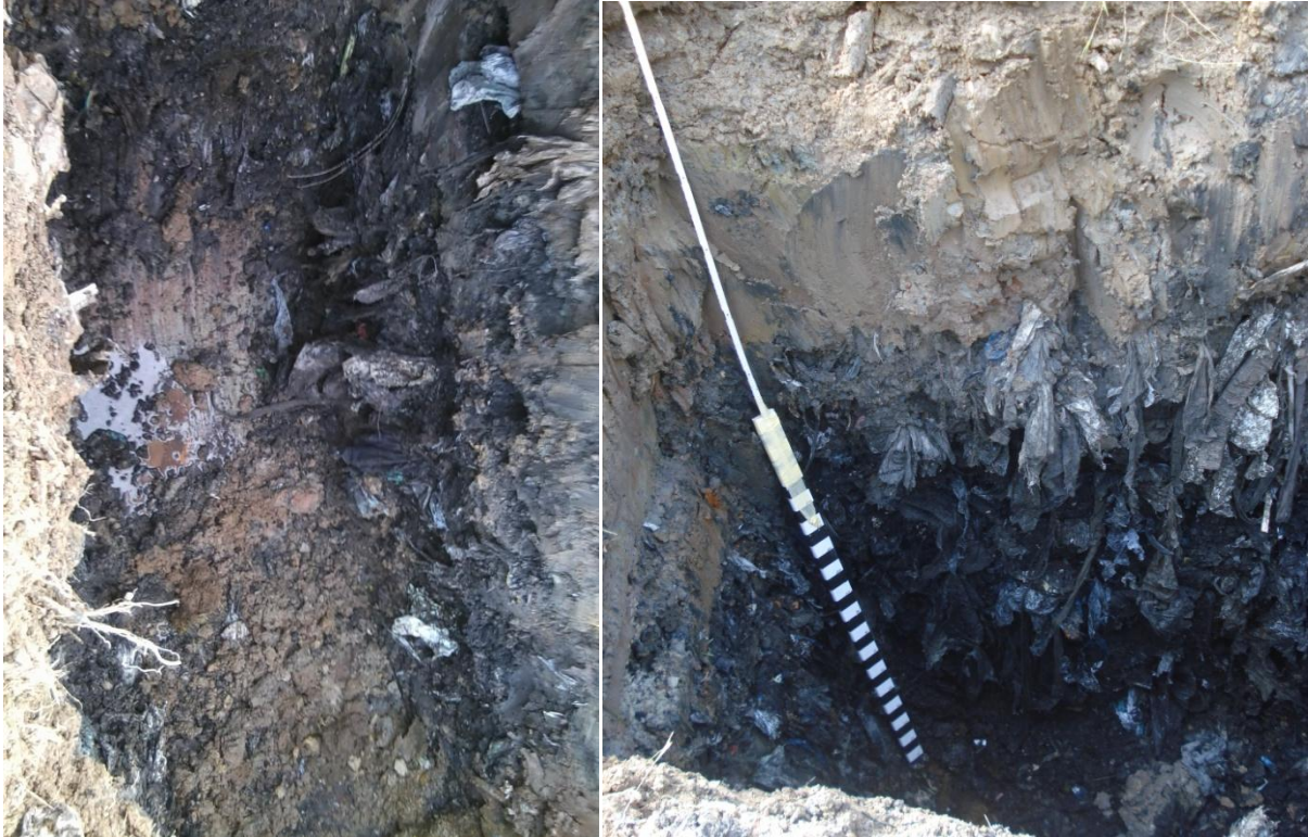
Bild 1: Schurf zur Entnahme von Proben des Altmülls
