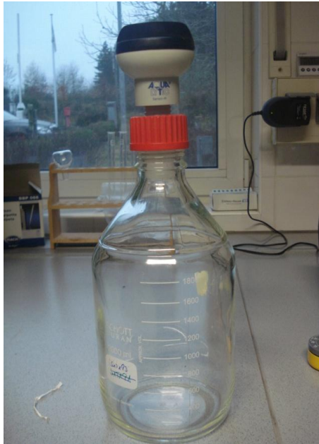
Bild 5-2: Sensomat Messsystem zur Bestimmung der Atmungsaktivität
