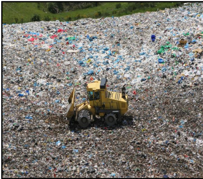
Bild 4-2: Einbau der Abfälle mit dem Kompaktor
