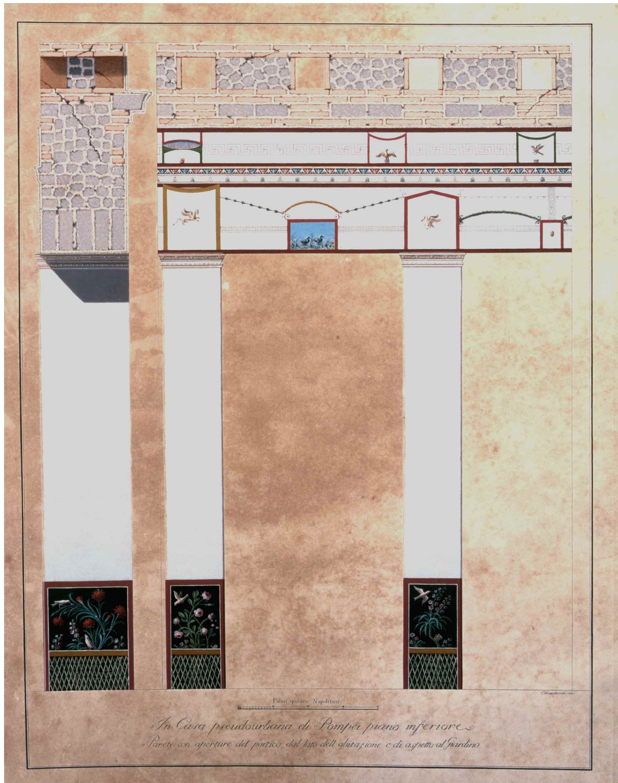
Abb. 151 - Portikus 5e. Dekoration der Pfeiler und der Innenseite des Epistyls im Mittelteil der Halle nach G. Chiantarelli. Die doppelten Balkenlöcher über den Pilastern gehören zur höher liegenden Holzdecke im Mittelteil der Portikus und einem Balkon vor dem Festsaal 4,9 im Stockwerk darüber.
