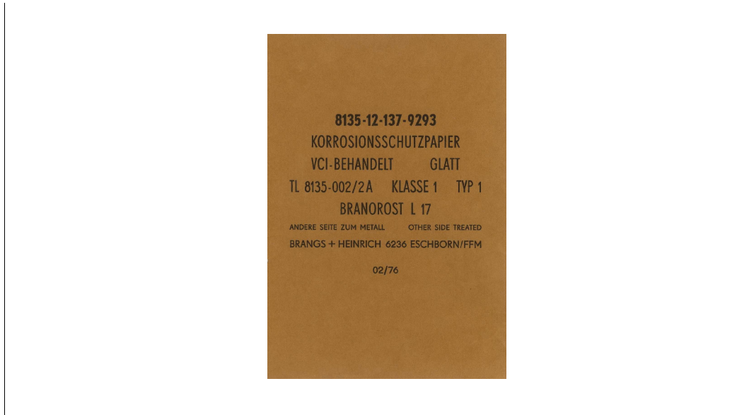
Abb. 13: Korrosionsschutzpapier nach TL 8135-002; DIN A4 (SgRB).
