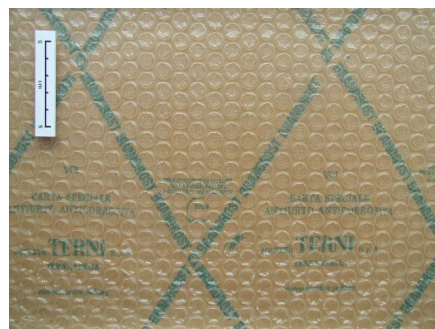
Abb. 981: TERNI; eine interessante Produktschöpfung; das Papier wurde mit einer Luftpolsterfolie kaschiert, also: VCI-Schutz nach innen, Polsterschutz nach außen. Die Werbeaussage ist durch die Luftpolsterfolie hindurch noch lesbar; 3/1987; K1 + S2.
