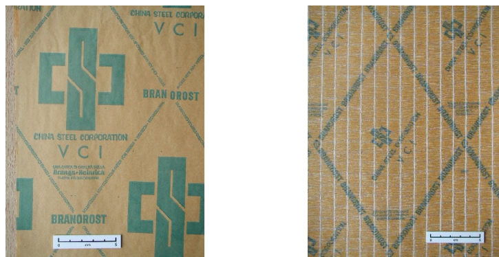
Abb. 901: CHINA STEEL CORPORATION, ein taiwanesisches Stahlunternehmen. Die Lieferungen gehen auf 1975 und 1985 zurück, ersichtlich an den unterschiedlichen Rauten; beide K1 + S2.
