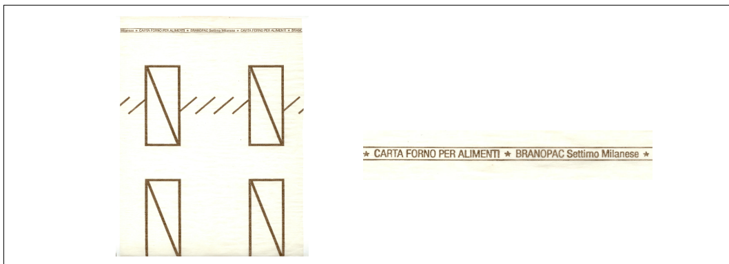
Abb. 1004: Der große italienische Backwarenhersteller BARILLA verlangte ein Raster für die optisch-maschinelle Positionierung der Backstücke. Auf Eigenwerbung verzichtete er. Die Herstellerangabe mit Produkt und Adresse duldete er jedoch; rechts: Detail mit Herstellerhinweis; ca.1990.
