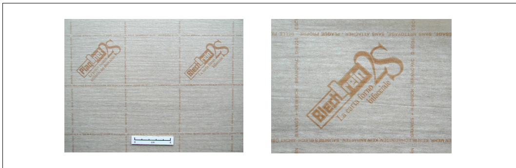
Abb. 999: Blechrein mit zweiseitiger Beschichtung und Druck; rechts: Detail.
