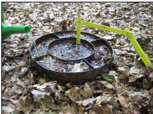
Foto 4.1: Doppelring-Infiltrometer
